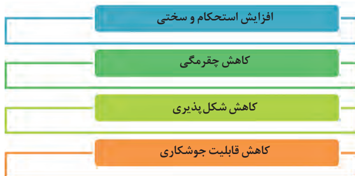
نمودار ۹- اثر افزودن کربن بر خواص فولاد
