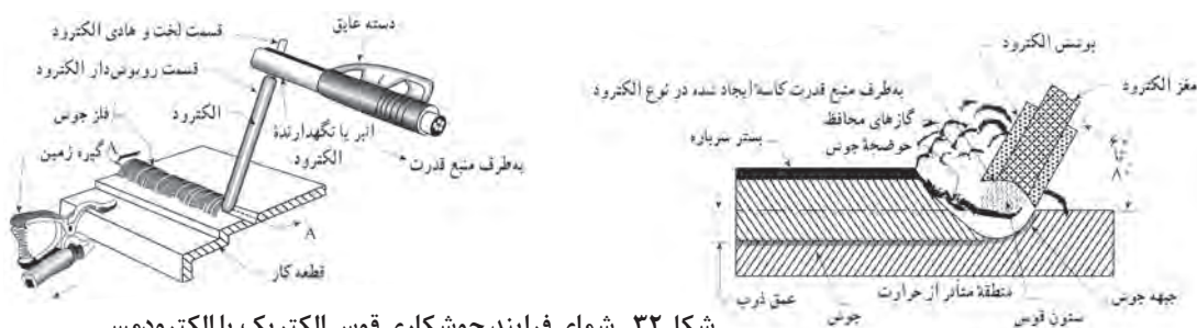
شکل ۳۲- شمای فرایند جوشکاری قوس الکتریک یا الکترودمسی
