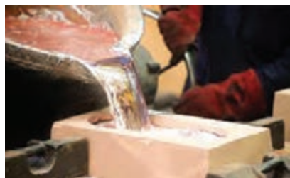
شکل ۳- ریخته‌گری فلز آلومینیوم
